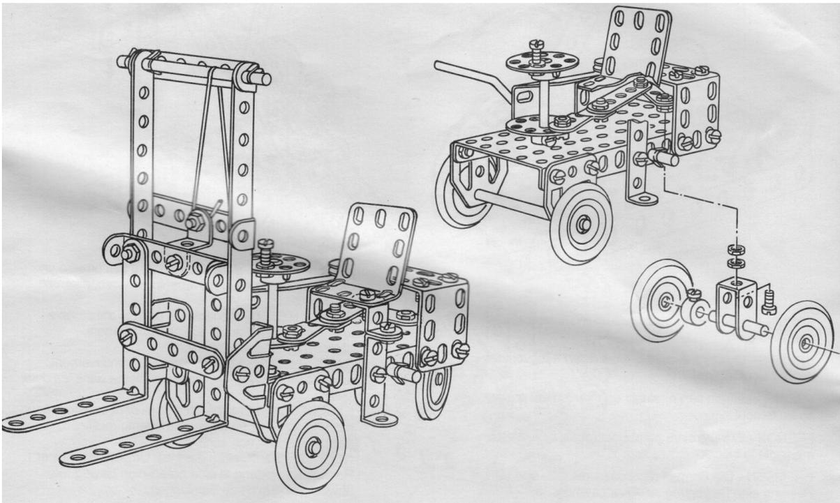
*Carrello elevatore con sistema di sterzo*
