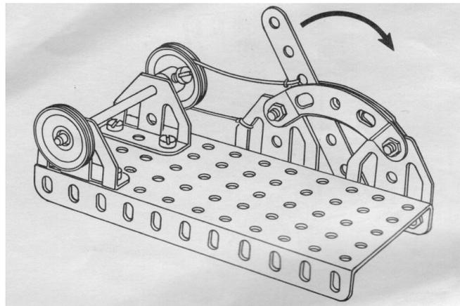
*Sistema di frenatura di un albero in rotazione*
